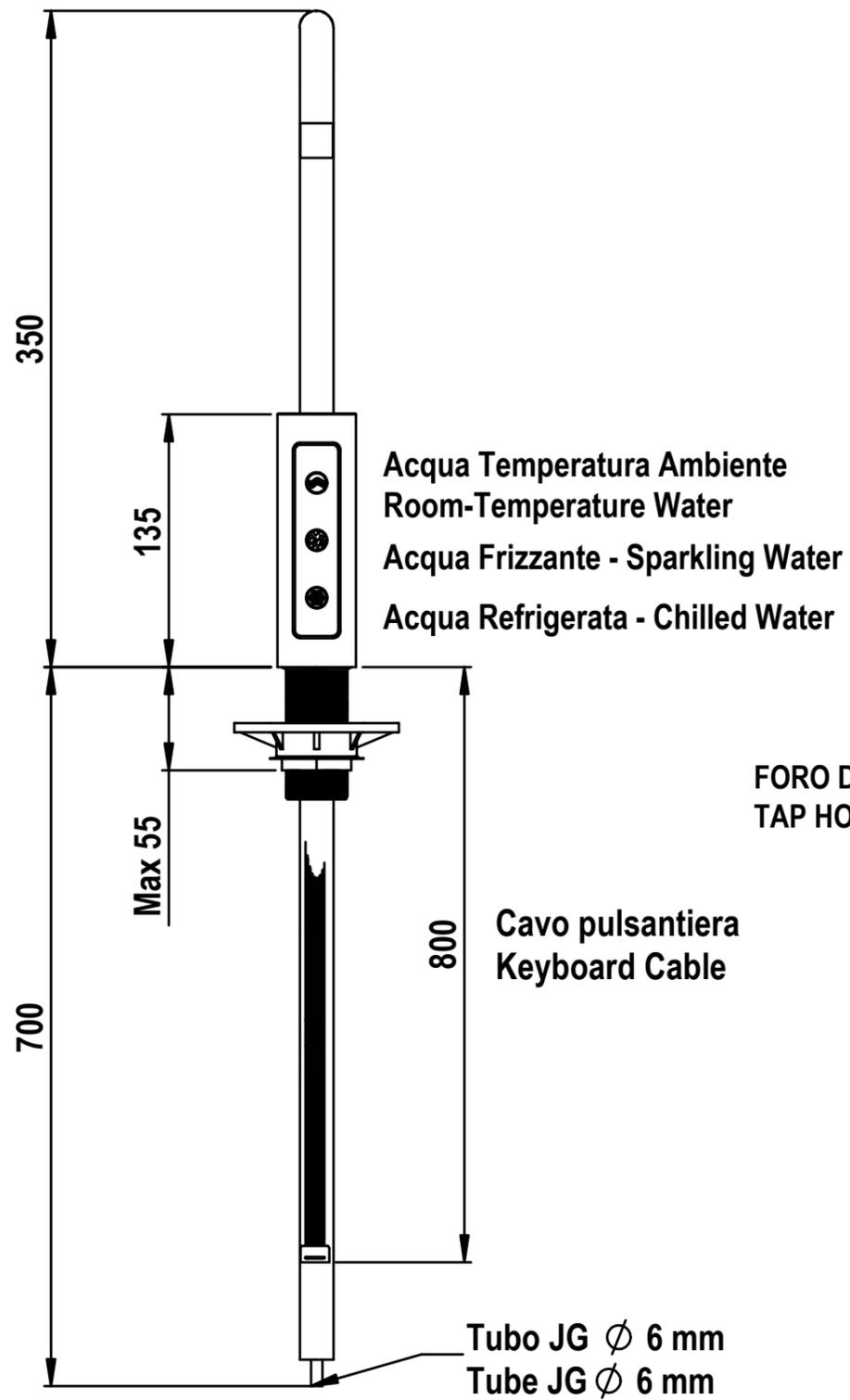
FORO DI INSTALLAZIONE  $\phi$  35 MM
